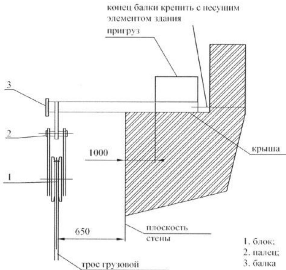
Схема запасовки сигнального каната
